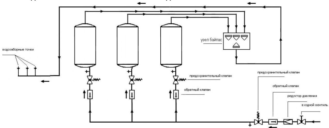
Схема обвязки водонагревателя с линией циркуляции
